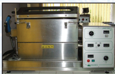
Fig. 70. Jigher automat (latine 500 mm) pentru pregatirea si vopsirea materialelor textile in foaie lata
