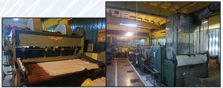
Fig. 76. Linia tehnologica experimentală pentru obținerea filtrelor textile netesute
