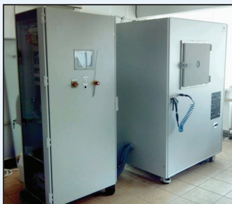
Fig. 74. Instalatie de plasma tip 400 CD roll-to-roll (Firma producatoare Europlasma din Belgia)
