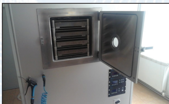
Fig. 57. Incinta de vidare de la instalatia de plasma
