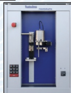
Fig. 68. Modul pentru determinarea rezistentei la tractiune a fibrelor textile (Firma producatoare Textechno din Germania)
