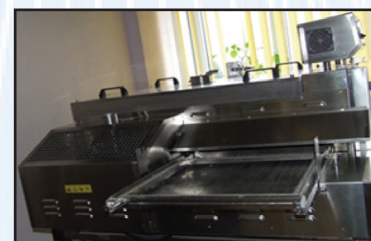
Fig. 72. Aparat de uscare-termofixare-condensare-vaporizare (model TFO/S 500 mm) pentru operatii intermediare si finale de finisare superioara
