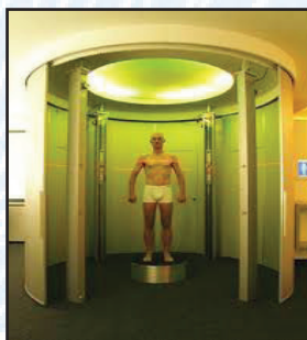
Fig. 73. Sistem mobil de masurare 3D automata a corpului (Firma producatoare Human Solutions GmbH din Germania)
