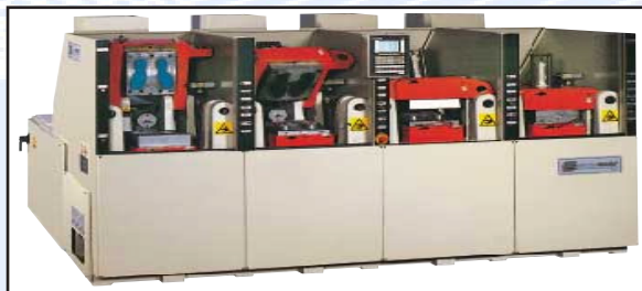
Fig. 84. Masina de injectie ORCA bicolor
