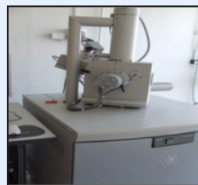
Fig. 74. Microscop electronic SEM (Firma producatoare FEI din Olanda)
