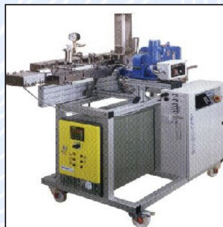
Fig. 67. Extruderul cu snec dublu, TSE35
