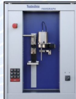
Fig. 73. Modul pentru determinarea rezistentei la tractiune a fibrelor textile (Firma producatoare Textechno din Germania)
