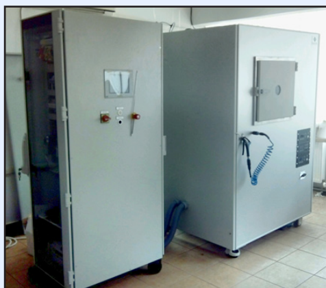
Fig. 79. Instalatie de plasma tip 400 CD roll-to-roll (Firma producatoare Europlasma din Belgia)
