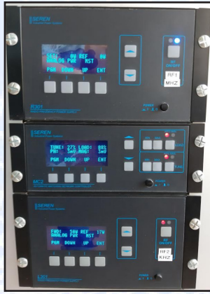
Fig. 62. a. Generatoare RF KHz / MHz
