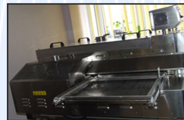
Fig. 77. Aparat de uscare-termofixare-condensare-vaporizare (model TFO/S 500 mm) pentru operatii intermediare si finale de finisare superioara
