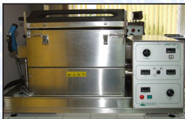
Fig. 75. Jigher automat (latine 500 mm) pentru pregatirea si vopsirea materialelor textile in foaie lata
