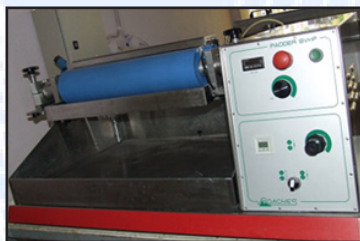
Fig. 76. Fulard cu doua valturi oscilante vertical/orizontal (model BVHP 500/100) pentru impregnarea materialelor textile cu substante polimerice si de functionalizare
