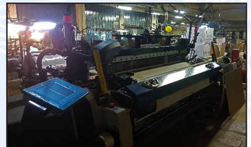
Fig. 82. Masina de tesut cu graifer Picanol OPTIMAX-4-R 210
