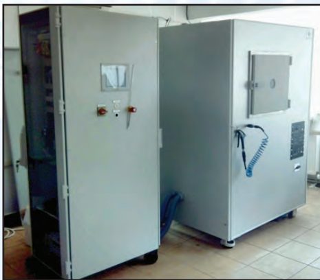
Fig. 62. Instalatie de plasma tip 400 CD Roll-to-roll (Furnizor Europlasma Belgia)
