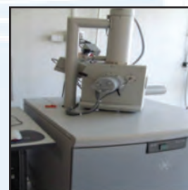
Fig. 70. Microscop electronic SEM (Firma producatoare FEI din Olanda)
