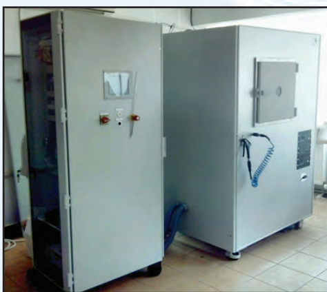
Fig. 75. Instalatie de plasma tip 400 CD roll-to-roll (Firma producatoare Europlasma din Belgia)
