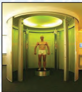
Fig. 74. Sistem mobil de masurare 3D automata a corpului (Firma producatoare Human Solutions GmbH din Germania)
