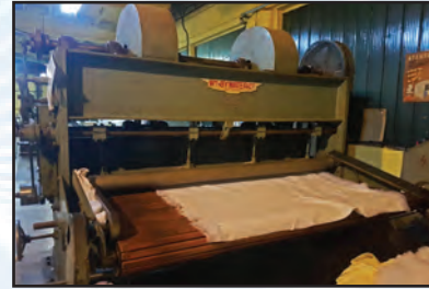
Fig. 77. Linia tehnologica experimentală pentru obținerea filtrelor textile netesute
