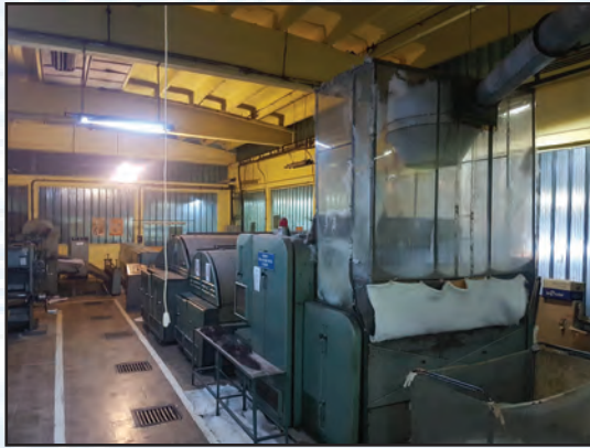
Fig. 77. Linia tehnologica experimentală pentru obținerea filtrelor textile netesute
