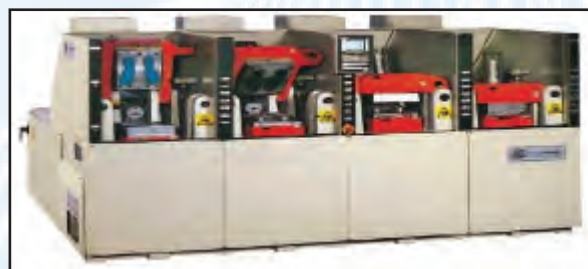
Fig. 76. Masina injectie ORCA bicolor (Firma producatoare Main Group din Italia)
