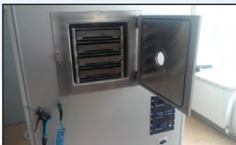
Fig. 63. Incinta de vidare de la instalatia de plasma
