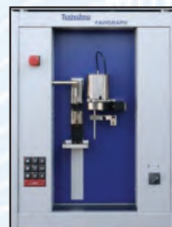
Fig. 69. Modul pentru determinarea rezistentei la tractiune a fibrelor textile (Firma producatoare Textechno din Germania)
