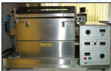
Fig. 71. Jigher automat (latime 500 mm) pentru pregatirea si vopsirea materialelor textile in foaie lata
