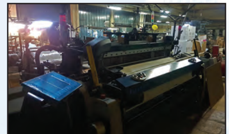
Fig. 78. Masina de tesut cu graifer Picanol OPTIMAX-4-R 210
