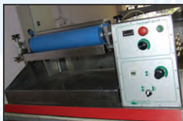
Fig. 72. Fulard cu doua valvuri oscilante vertical/orizantal (model BVHP 500/100) pentru impregnarea materialelor textile cu substante polimerice si de functionalizare
