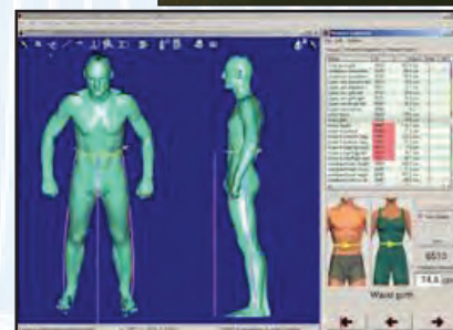
Fig. 68. Sistem mobil de măsurare 3D automată a corpului
