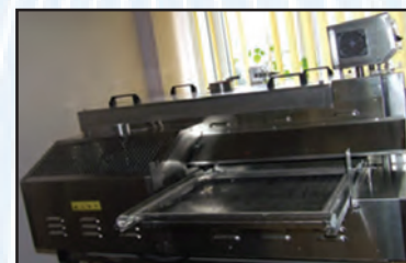
Fig. 73. Aparat de uscare-termofixare-condensare-vaporizare (model TFO/S 500 mm) pentru operatii intermediare si finale de finisare superioara
