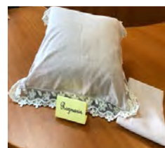
Tesatura 70% bbc/30% canepa tratata cu microcapsule de rozmarin
