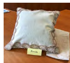
Tesatura 70% bbc/30% in tratata cu microcapsule de lavanda
