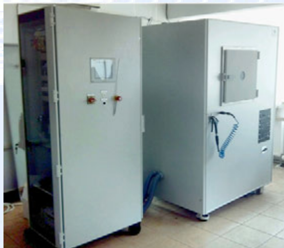
Fig. 68. Instalatie de plasma tip 400 CD Roll-to-roll (Furnizor Europlasma Belgia)
