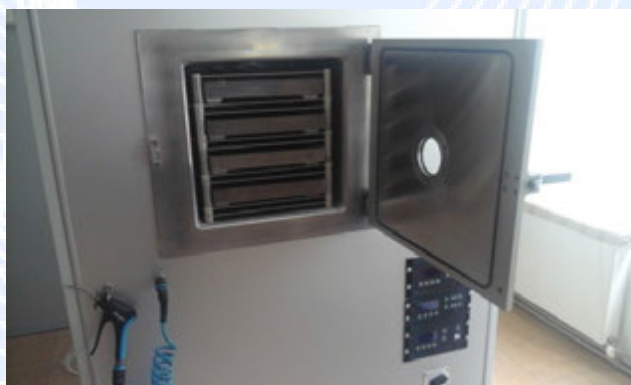
Fig. 69. Incinta de vidare de la instalatia de plasma
