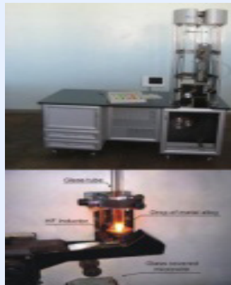
Fig. 71A. Echipament pentru obtinerea din topitura de aliaje, de micro filament
