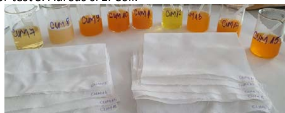
Figura 7. Probe experimentale de materiale textile tratate cu hidrogeluri pe baza de APV si Colagen si diferite principii active
