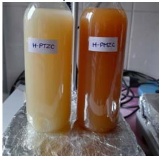
Figura 3. Prototipuri de hidrolizate de colagen obtinute din deseuri de piei organice, TZC 2 si MZC 2
