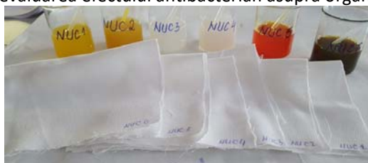
Figura 6. Probe experimentale de materiale textile tratate cu hidrogeluri pe baza de APV si PEG si diferite principii active
