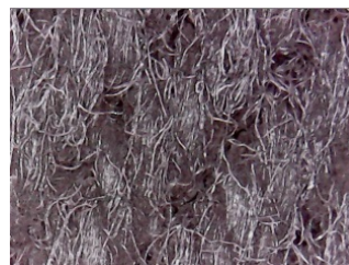
b. Tesatura cu pasta pe baza de PVA si Ni depusa dupa tratarea in plasma
