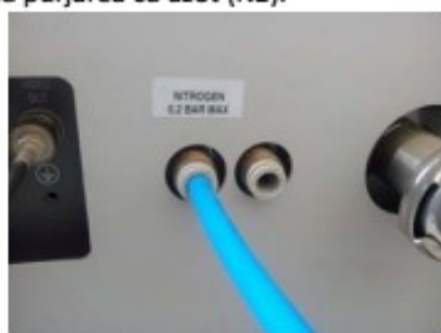
Fig. 1. Cupla rapidă utilizată la fixarea tubului flexibil (a) de racordare la reductorul buteliei de azot (b)
