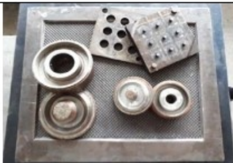
Figura 2. Matrițe pentru garnituri de etansare și dopuri
