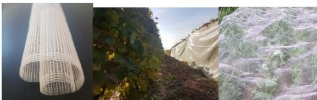
Fig. 2 Imagine model experimental produs tricostat agrotexstil si fotografii experimentare
