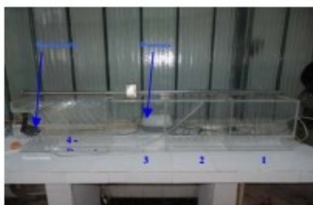
Fig.1. Model experimental instalatie de epurare tip MBBR (1;2 bazin aerob cu 6 difuzori metalici perforati,3 bazin anoxic cu mixer, 4 decantor lamelar cu 8 lame
