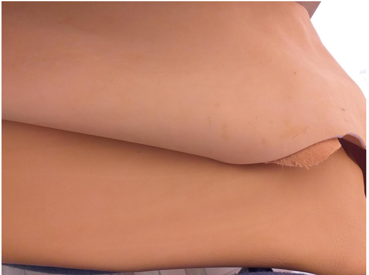
Piei retanate cu extracte polifenolice din turte de masline, aditivate cu proteine
